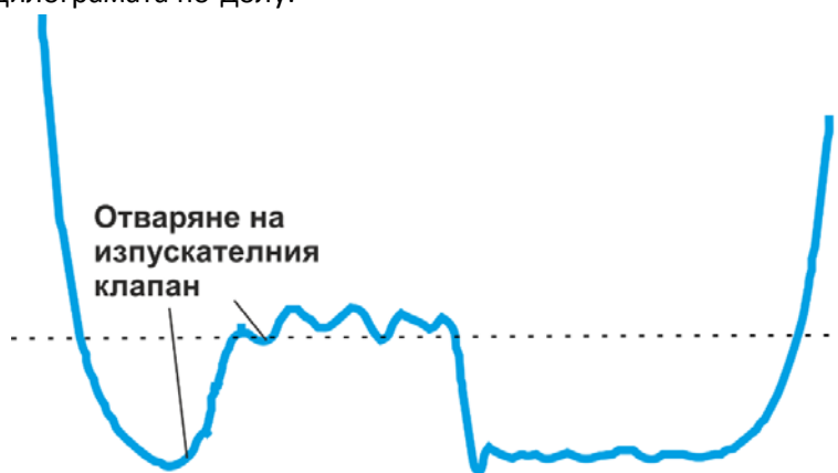
Фиг.3. Значително износване на направляващата втулка на изпускателния клапан
